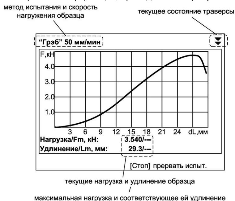
Рисунок 9 – График нагружения
