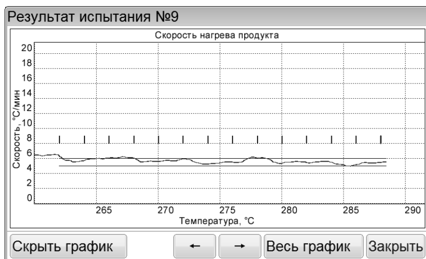
Рисунок 15 – Окно «Результат испытания»: график, зона поджига
